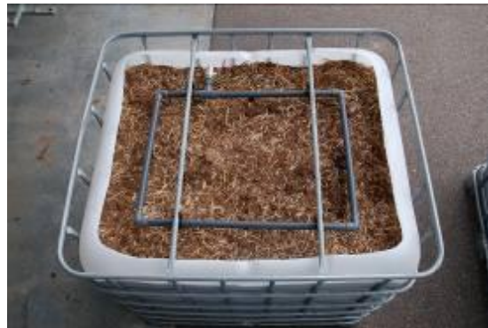
Foto 8: Verdeling van het water over de Biomix
