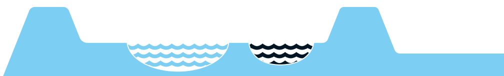
Rivierverruiming - in plaats van dijkversterking
